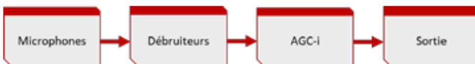
Figure 4. Chaîne traditionnelle en série de traitement du signal.
