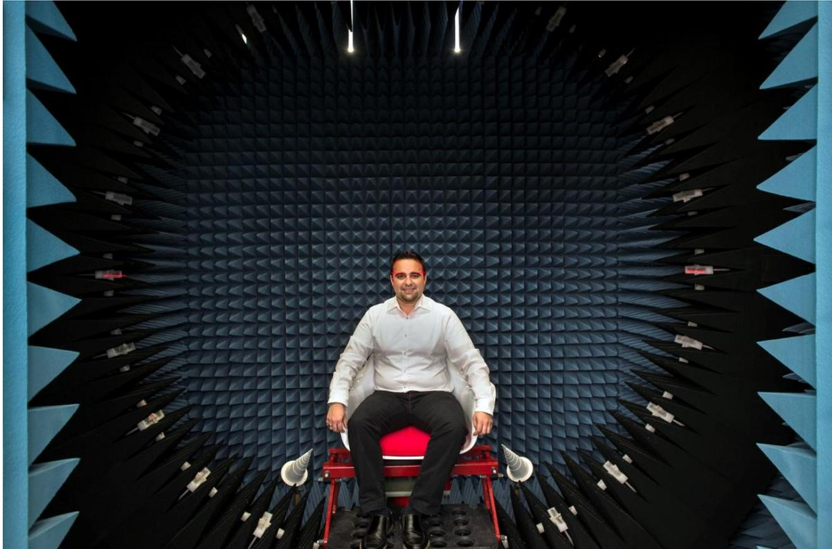
**Abbildung 3:** Prüfung der RF-Antennenleistung in der Antennen-Messkammer in Erlangen. Die Testkammer selbst ist gegen schwächste elektromagnetische Felder abgeschirmt, so dass die Funksignale der Hörsysteme genau gemessen werden können.
